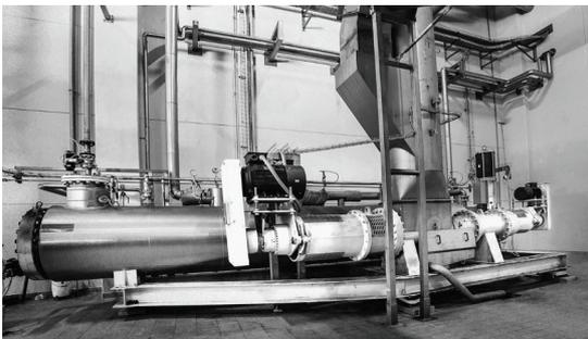
Die Haarslev-Serie kontinuierlicher Hydrolysatoren sind die fortschrittlichsten und benutzungsfreundlichsten Maschinen. Die Hydrolysatoren dienen speziell der Verarbeitung von Federn und Schweineborsten. Bei der Entwicklung des CFH Hydrolysators konnten wir auf langjährige Erfahrung in der Beseitigungsindustrie zurückgreifen. Das Ergebnis ist ein hoch verlässlicher und energieeffizienter Hydrolysator.
