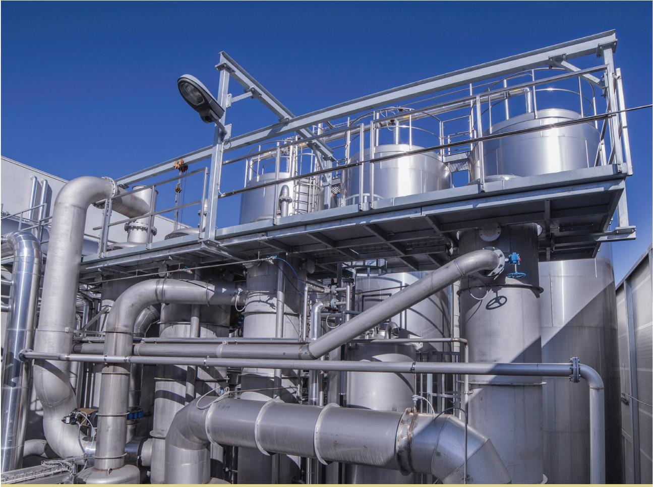
**Ein MVR-Verdampfer, der unter atmosphärischem Druck arbeitet, benötigt kein Kühlwasser. Ein MVR-Verdampfer, der unter Vakuum arbeitet, benötigt nur eine geringe Menge an Kühlwasser. Der Dampf vom Lüfter wird indirekt kondensiert.**
