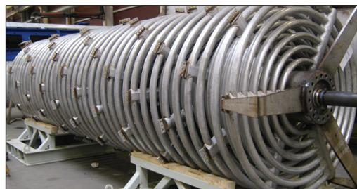
Der Condi Dryer kann als Vakuumtrockner produziert und optional mit angepasstem Fliehkraftabscheider und Ventilator ausgestattet werden.
