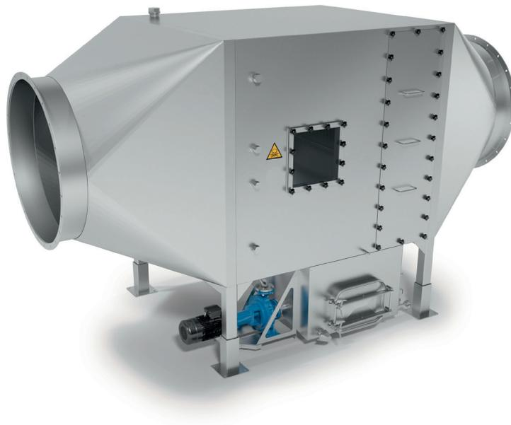
Der Luftbefeuchter wird vollständig mit Tropfenfänger, Umwälzpumpe und erforderlichen Ventilen geliefert. Die gesamte Einheit ist in Edelstahl gefertigt, der Tropfenfänger aus Polypropylen oder Edelstahl. Die Einheit ist platzsparend, da alle Komponenten von
