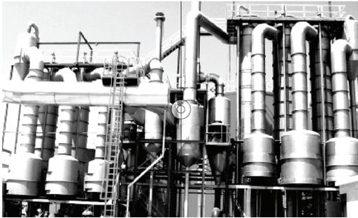
Die Verdampfer von Haarslev optimieren die Nutzung der Rohmaterialien, steigern die Erträge der Anlage und senken den Energieverbrauch, während sie gleichzeitig auch die Belastung der Umwelt minimieren. Die Anwendungen reichen von Fischmehl über Tierkörperverwertung bis hin zur Herstellung von alkoholischen Getränken und Bioethanol.
