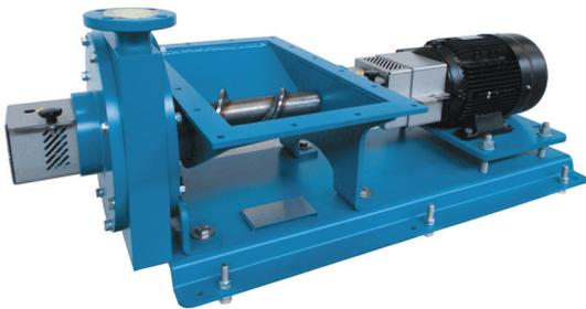
**Die Haarslev Talgpumpe ist eine Kreiselpumpe mit Zuführschnecke zum Pumpen von verflüssigtem Tierfett und anderen hoch viskosen Stoffen, die kleinere Partikel enthalten.**
