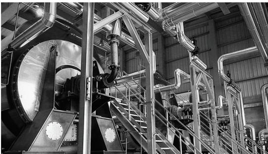
**Der Haarslev Disc Dryer wird indirekt dampfbeheizt und dient dem kontinuierlichen Garen oder Trocknen von Tiernebenprodukten oder Fisch. Der Rotor besteht aus einem zentralen Rohr, auf dem doppelwandig verkleidete Scheiben vertikal und parallel angeschweißt sind. Dieser Entwurf sorgt für eine konzentrierte Heizfläche mit maximaler Verdunstungskapazität in einem kompakten Design.**
