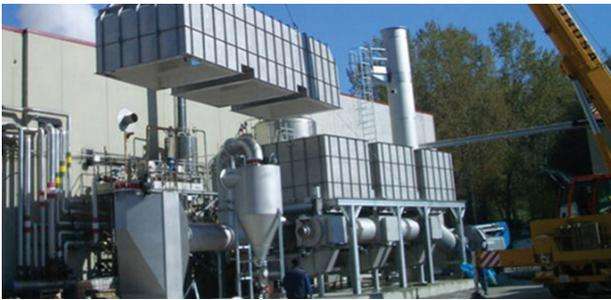
Ein speziell entworfener Niedrigenergie-Brenner hält die Temperatur in der Brennkammer auf mindestens 850 °C. Gardampf und/oder Prozessluft wird über einen der Kanister in die Brennkammer geleitet, wo sie durch die Oxidation in weniger schädliche, geruchsfreie Komponenten umgewandelt werden.
