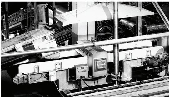
Haarslev Metalldetektoren dienen der Abscheidung von Metall aus rohem oder gegartem Material. Sie sind mit einem Detektorkopf ausgestattet, dessen Empfindlichkeit auf unterschiedliche Anforderungen eingestellt werden kann.
