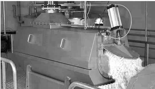
Haarslev bietet eine bewährte Palette an robusten Federpressen an, die in Sekunden angepasst werden können. Die Presse ist wartungsarm und zahlt sich auf beeindruckende Weise aus, nämlich über Energieeinsparung bei der weiteren Verwertung sowie durch Gewichtseinsparung bei entgeltlicher Federnentsorgung aufgrund der großen Wassermenge, die entzogen wird.
