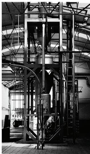
Der vertikale Hydrolysator von Haarslev wird zur Verarbeitung von Federn und Schweineborsten eingesetzt, die Lebensmittel werden somit sehr verdaulich.
