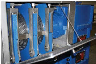
Die Haarslev Twin Screw Press sichert eine effiziente mechanische Entwässerung und Reduzierung des Öl-/Fettgehalts, was die Verarbeitung verbessert und das Energie-Einsparpotenzial erhöht.
